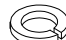
7 x4 Lock washer M6 * x4 Rondelle de blocage M6 x4 Arandela de Seguridad M6
