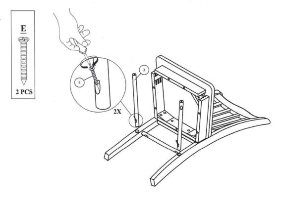
DO NOT TIGHTEN SCREW COMPLETELY.
