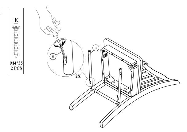
DO NOT TIGHTEN SCREW COMPLETELY.
