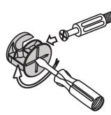
The head of the mini fix housing goes into the open mouth of the mini fix bolt. You then turn the mini fix housing so it tightens over the mini fix bolt.
