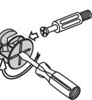
The head of the mini fix housing goes into the open mouth of the mini fix bolt. You then turn the mini fix housing so it tightens over the mini fix bolt.
